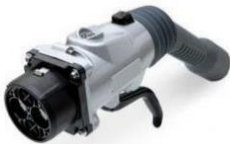
Figura 6.6 Exemple de connector CHAdeMO. [19]
