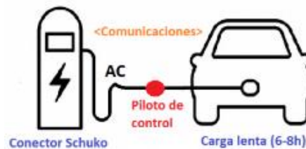
Figura 7.3 Esquema del mode de recàrrega 2. [24]
