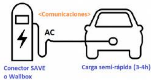
Figura 7.6 Esquema del mode de recàrrega 3. [24]
