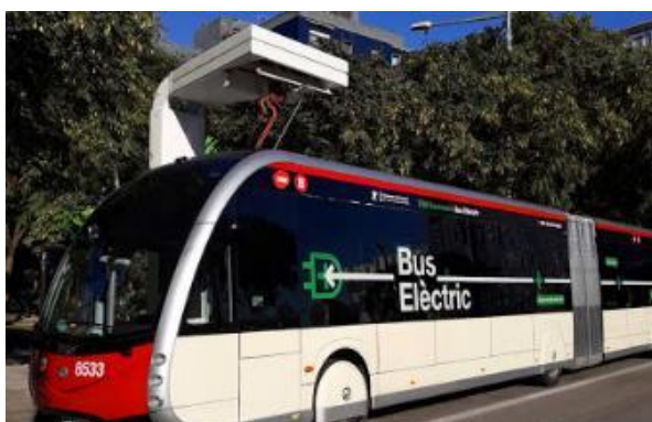
Figura 7.11 Punt de càrrega amb pantògraf per autobusos elèctrics. [35]
