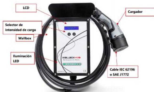
Figura 7.7 Exemple típic d'un Wallbox (Marca: WallboxOK). [30]
