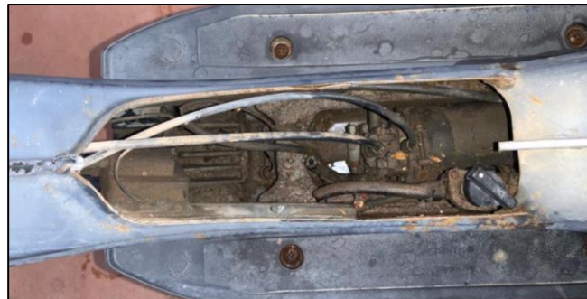
Figura 2.2 Vista del interior amb el carburador i l'alimentació 2
