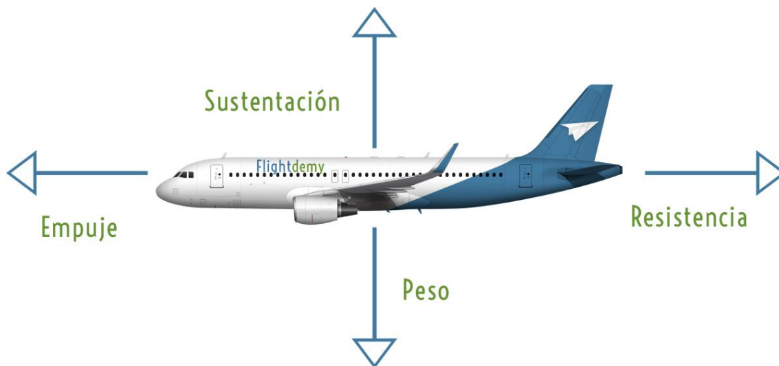
Figura 2.5. Las 4 fuerzas que actúan sobre un avión en vuelo. [Fuente:gcs.co.uk]
