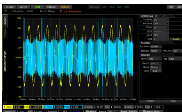
Figura 32.- Captura oscil·loscopi amb soroll.
