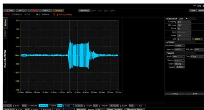
Figura 44.- Captura oscil·loscopi, aspecte recepció.
