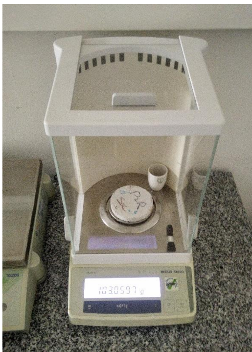
Figura 10. Balanza utilizada para el pesaje de las muestras para sorción de sorción. Laboratorio de materiales – DECA.
