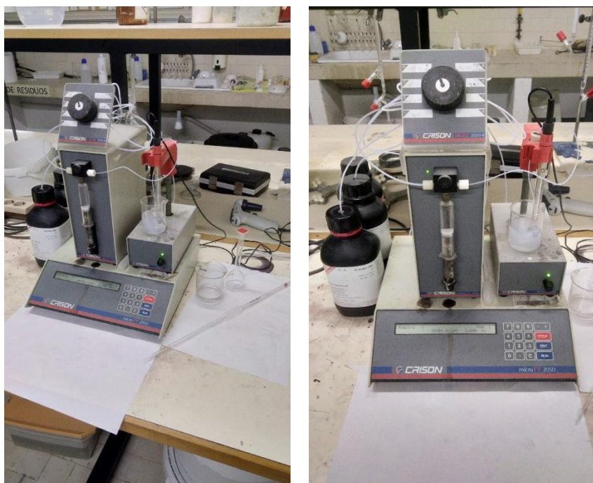
Figura 12. Equipo de titración utilizada para la determinación de cloruros libres en las muestras. Laboratorio de materiales – DECA.
