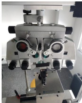
Imatge 2 Sistema de Hartmann-Shack (HS) per la monitorització de l'acomodació desenvolupat al CD6, caixa metàl·lica inferior, incorporat en un foropter comercial utilitzar en clínica per la refracció.
