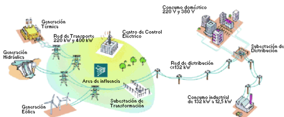
Figura 2.1. Esquema de l'estructura bàsica del Sistema Elèctric Espanyol. (Font: Red Elèctrica de España [7])
