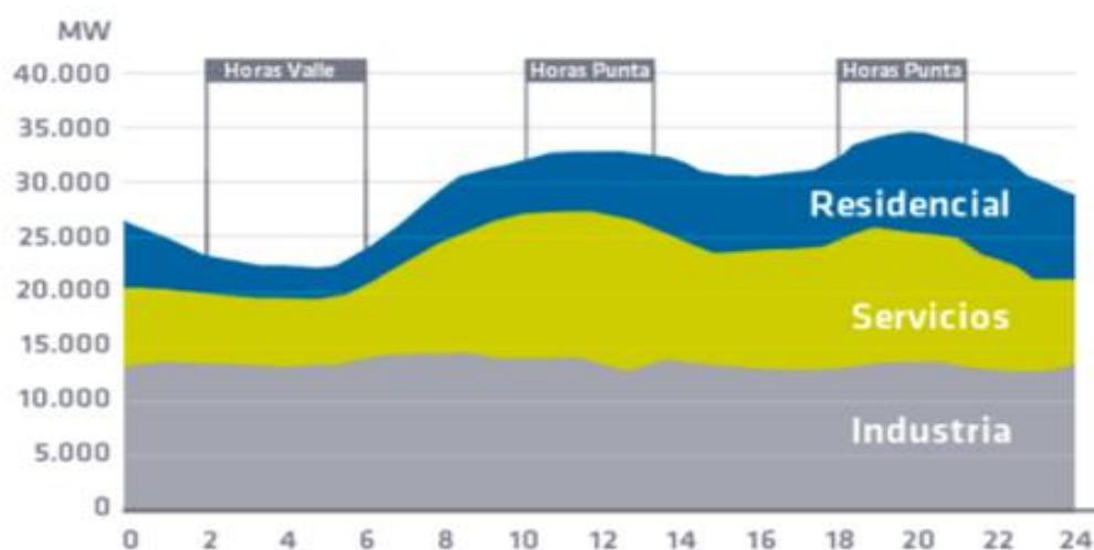
Figura 1 Percentatge Espanya de cada sector en el consum per hores. Font REE
