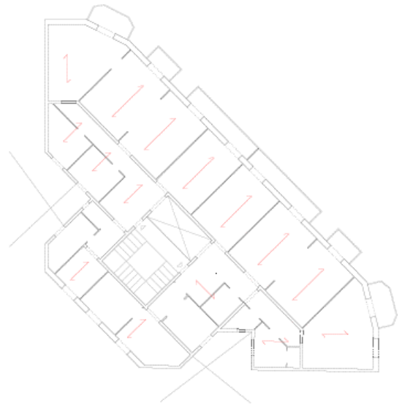
Figura 3.1.21 Plano estructural de la distribución en planta del edificio de la calle de Mallorca 312 extraído de Cornadó (2015)
