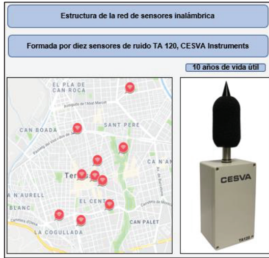
Figura 5. Estructura de la red de sensores de ruido inalámbrica de la ciudad de Terrassa. Fuente: Plataforma Sentilo (2019) y hoja de especificaciones técnicas del sensor TA 120 (CESVA Instruments)
