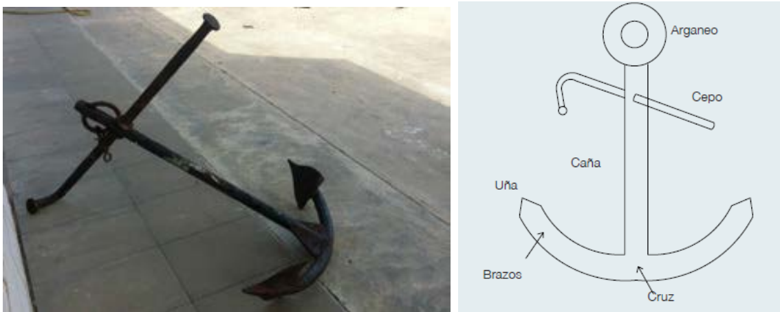
Figura 2.16 Partes de un ancla con cepo
