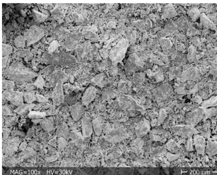
Ilustración A1. Fotografía SEM de la muestra 42BWR Core con escala 200 μm y aumento x100
