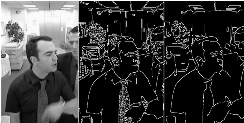
Figura 5.7: Detecció de contorns amb (dreta) i sense (centre) Gaussian Blur mitjançant Canny
