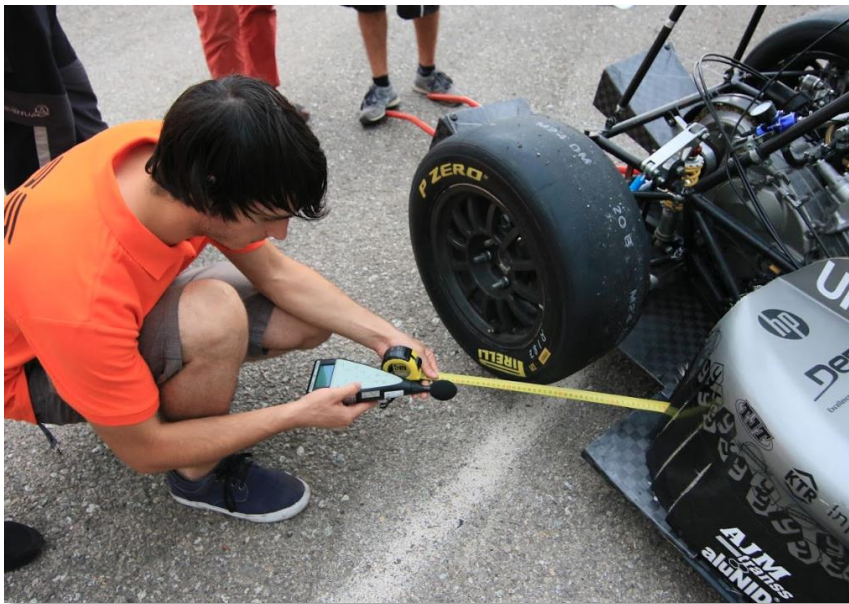
Imagen 3 Modo de medición de la sonoridad del sistema de escape. (Circuit de Catalunya 2018).
