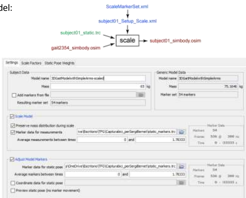
Figura 4.10: Esquema dels arxius necessaris a la funció Scale i interfície de l’eina Scaling a OpenSim
