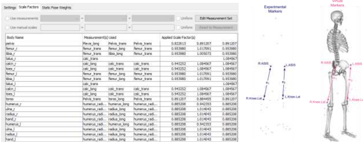
Figura 4.11: Exemple de factors d'escalat calculats mitjançant OpenSim i representació gràfica de la diferència entre marcadors experimentals i virtuals
