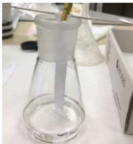
Figura 10 Test de capil·laritat vertical. Font propia
