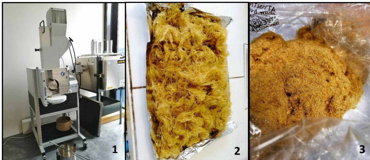
Figure 19. 1 : broyeur à couteaux ; 2 : Fibres avant broyage ; 3 : Fibres après broyage
