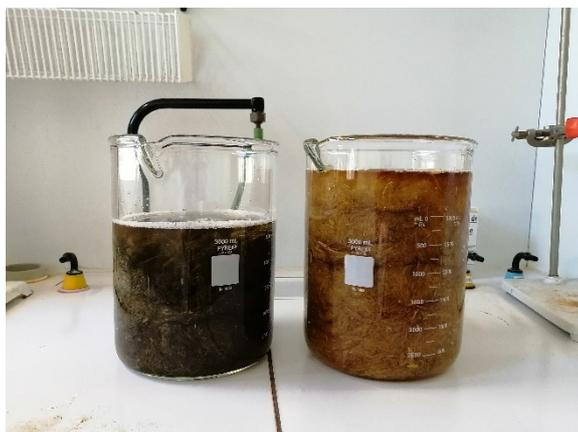
**Figure 17.** *Fibres jaunes et rouies dans la solution 5% de NaOH.*
