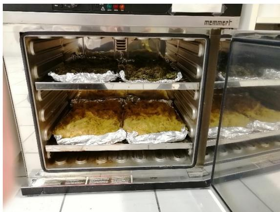
**Figure 18.** *Fibres jaunes et rouies dans le four après le lavage avec eau.*
