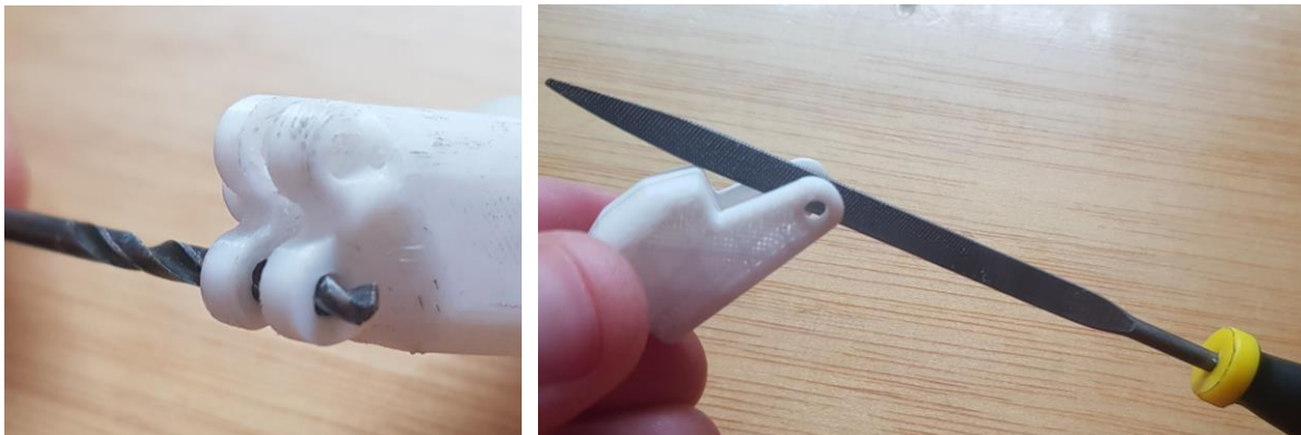
Figuras 73 y 74: Postprocesos de las piezas impresas por FDM
