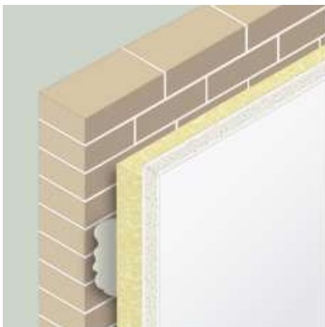
Imatge 27: Paret de Pladur amb aïllant
