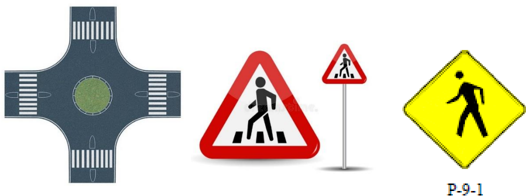
Figuras 12: Pasos de Cebra y señalización vertical de paso de peatón Fuente: Norma 8.2-IC "Señalización Vertical" y Catalogo de señales verticales /SIECA
