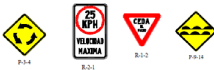
Figura 25: Señalización Vertical Fuente: Manual de la SIECA
