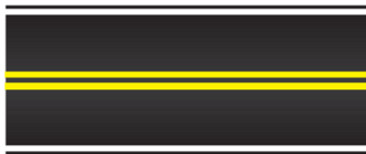
Figura 23: Dos Líneas continuas amarillas, Fuente: bibliocad.com
