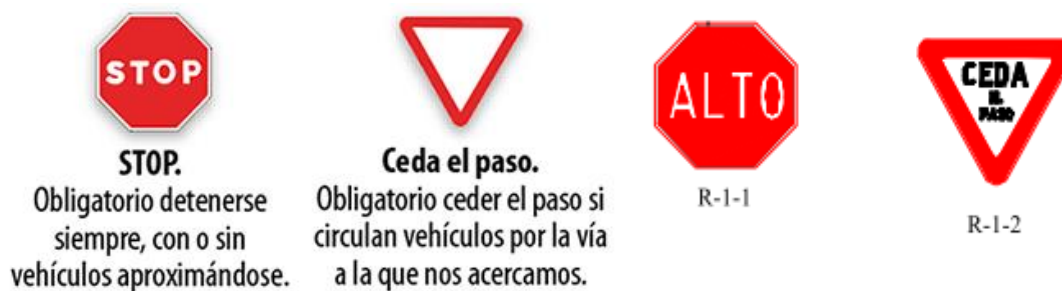
Figura 8: Señalización vertical stop y ceda el paso,
