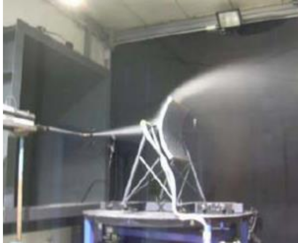
Figura 8.2. Posició de seguretat dels concentradors solars en condicions de vent elevades [24].
