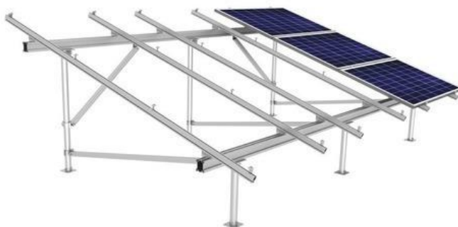
Figura 7.11. Disseny de l'estructura de 3 plaques d'alumini.
