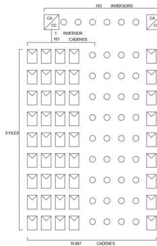
Figura 7.18. Esquema simplificat de la disposició del conjunt plaques-inversors.
