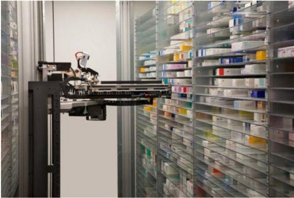
Figura 8. Sistema ROWA d'emmagatzematge i distribució de medicaments
