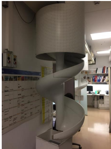
Figura 9. Rampa en espiral per baixar els medicaments des de la cinta transportadora al mostrador
