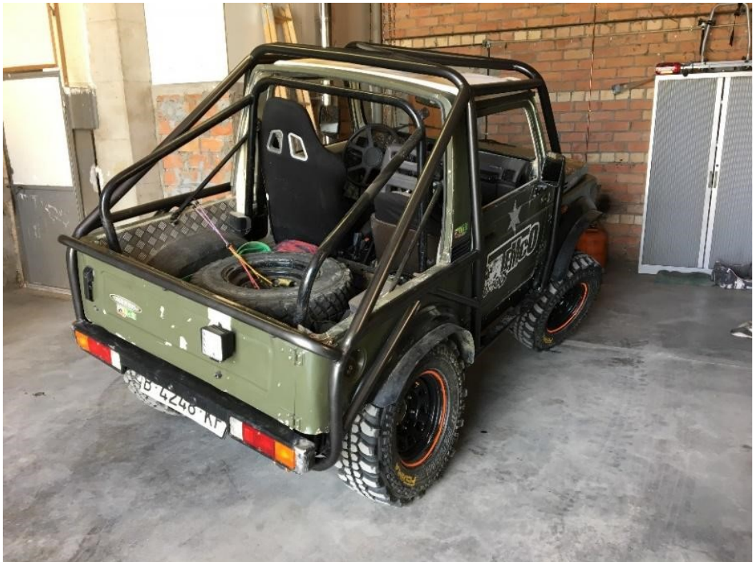
Imagen 38: Estructura de barras pintada y montada
