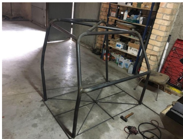
Imagen 34: Estructura barras central en proceso de soldadura
