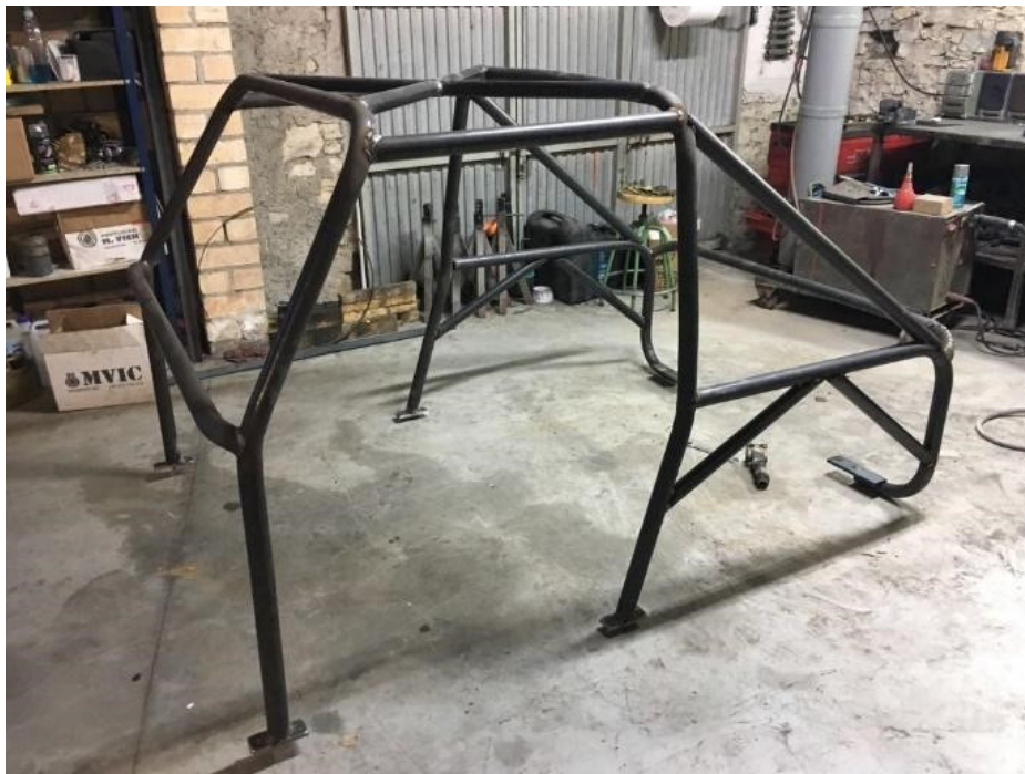
Imagen 37: Estructura de barras soldada y pulida
