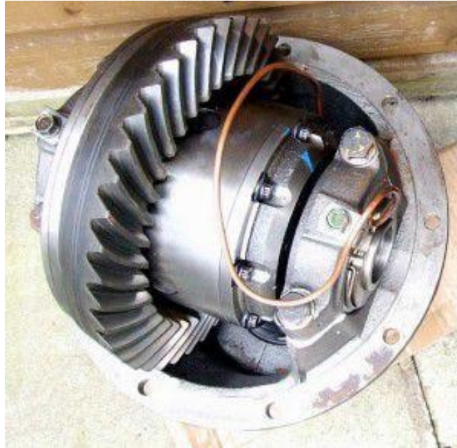
Imagen 12: Diferencial con el bloqueo ARB montado.
