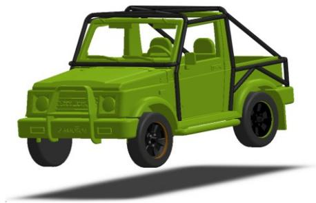
*Fig. 1. Diseño barras antivuelco*
