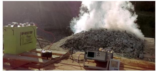
Figura 6. Imagen del equipo utilizado para realizar la monitorización del horno de yeso tradicional.
