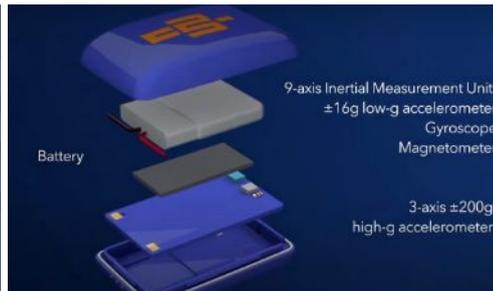
(Fig. 46 Explosionado del sensor IMU) [34]
