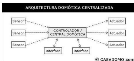
Figura 2.7 Arquitectura centralizada (Fuente: [9] www.casadomo.com )
