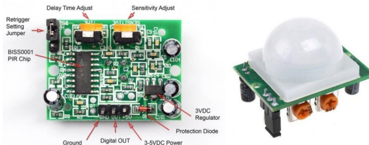
Figura 5.39 Sensor de movimiento PIR HC-SR501 (Fuente: [20] www.diotronic.com )
