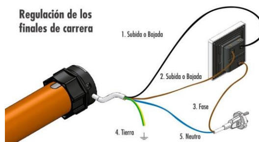
Figura 5.51 Repartición de los cables del motor tubular (Fuente: [31] www.fmautomatismos.com )
