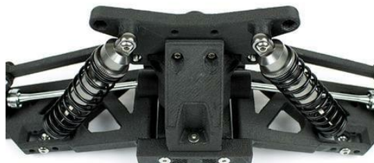
Figura71: Ejemplo de pieza imprimida con Termoplástico de Acrilonitrilo (ABS). Fuente: 3dlink.me
