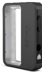
Figura 59: escáner 3DS Sense. Fuente: www.grupoabstract.com
