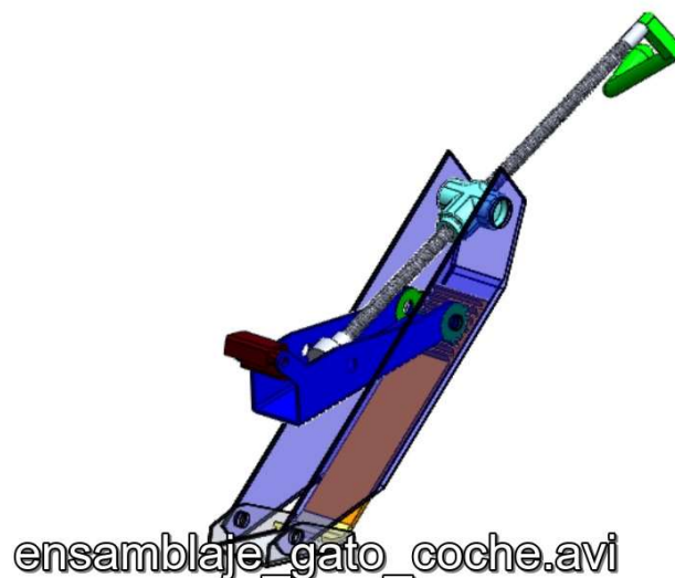
Figura 13. Captura de pantalla de la reproducción de la animación 3D del mecanismo gato mecánico. Para este mecanismo en particular, se ha decidido no realizar su materialización en plástico. Esto se debe a la gran complejidad geométrica de algunas de sus piezas y a la dificultad de materializarla por impresión 3D.
