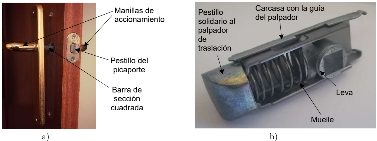
Figura 1. Mecanismo del picaporte: a) Mecanismo montado en la puerta, barra de sección cuadrada y manillas anterior y posterior de accionamiento b) Foto del picaporte y sus elementos constructivos.
