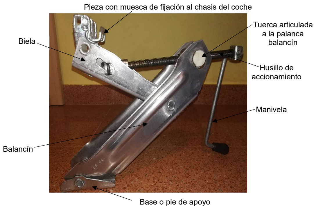
Figura 7. Foto de un gato mecánico de un coche, con indicación de las partes principales.
