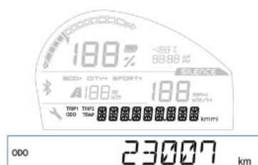
Figura 18: Detalle de la posición del indicador del cuentakilómetros.
