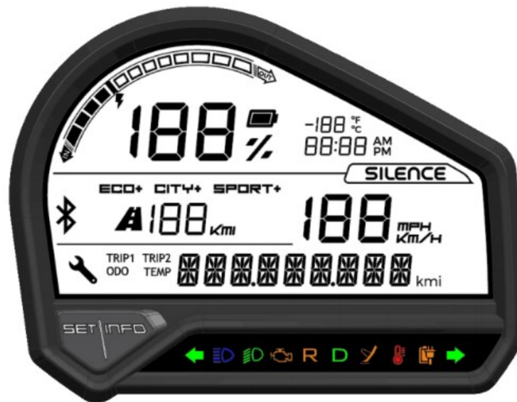
Figura 8: Detalle del cuadro de instrumentos de la S01.
