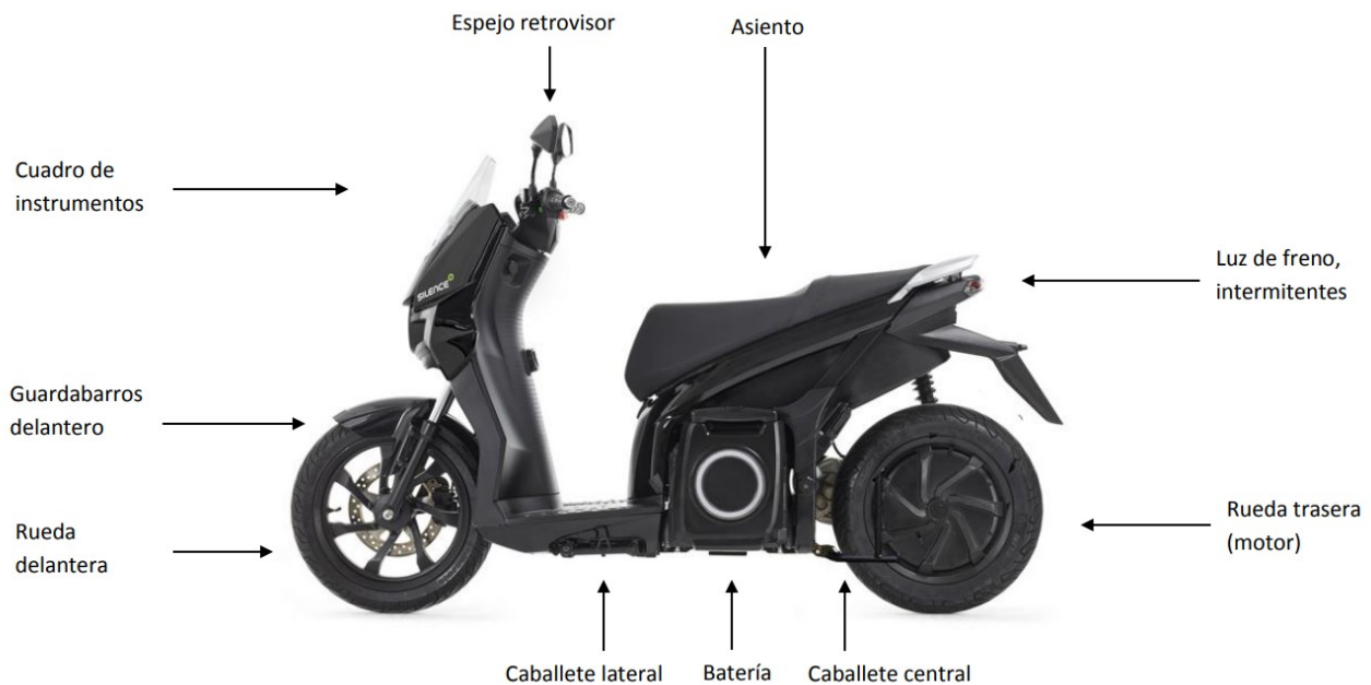
Figura 3: Componentes generales de la moto S01 de Silence.
