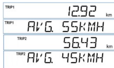
Figura 20: Indicador de cuentakilómetros y velocidades medias parciales.
