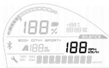
Figura 16: Detalle de la posición del indicador de velocidad en el cuadro de instrumentos.
