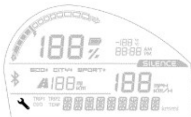
Figura 17: Detalle de la posición del indicador de servicio en el cuadro de instrumentos.
