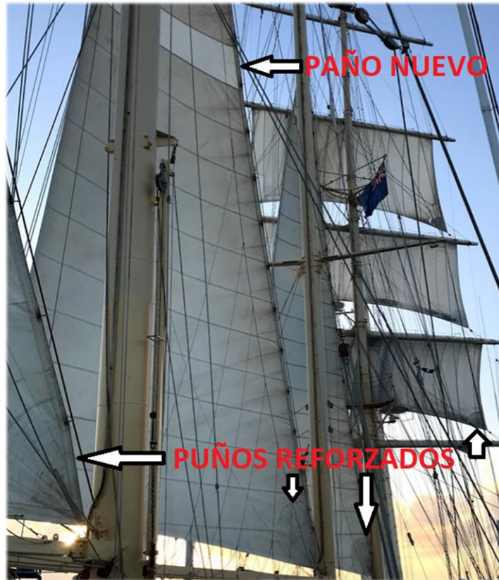
Figura 25. Puños y paños horizontales y verticales. Fuente: propia.
