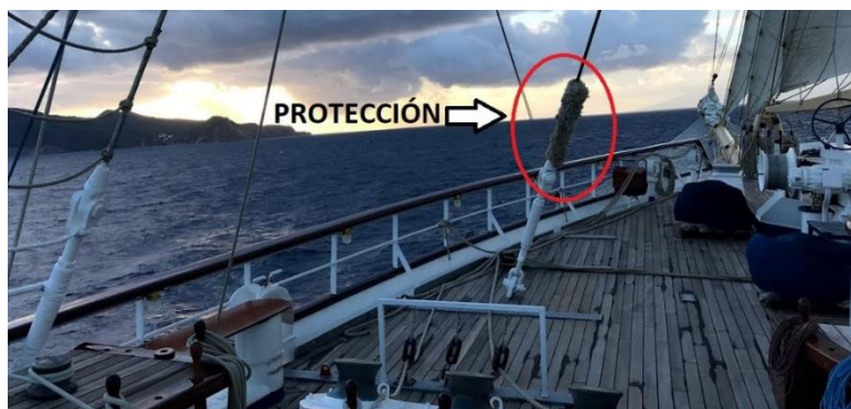
Figura 47. Protección en el obenque. Fuente: propia.
