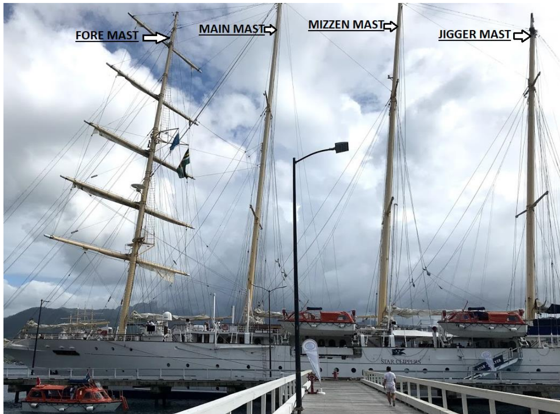
Figura 4. Mástiles. Fuente: propia.
