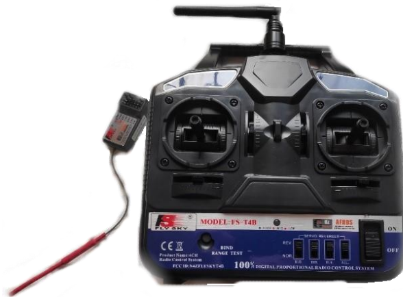
Figura 3.8. Mando (derecha) y receptor RC (izquierda) utilizado para controlar el dron (Fuente: Propia)
