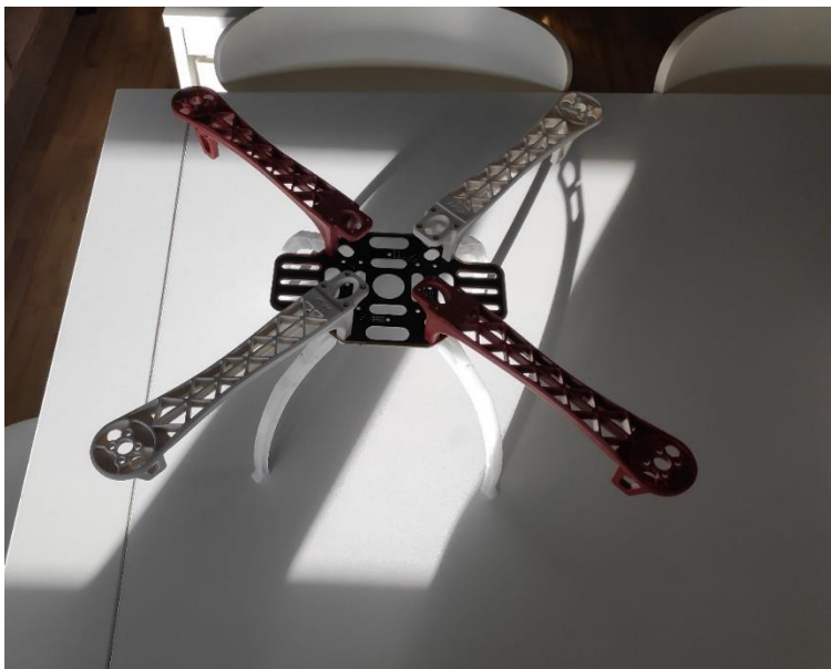
Figura 3.15. Chasis del dron tras escoger el tipo de estructura del dron, en forma de 'equis' (Fuente: Propia)
