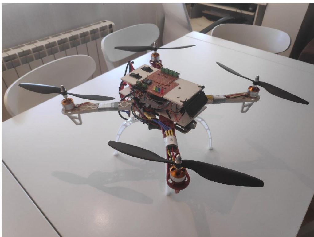
Figura 3.19. Dron del proyecto tras finalizar el montaje mecánico (Fuente: Propia)
