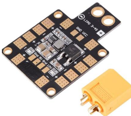
Figura 3.13. Placa que distribuye la potencia (Fuente: Propia)
