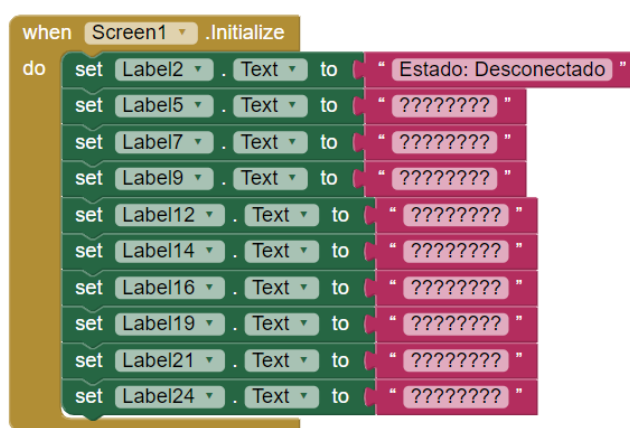
Figura 4.23. Programación en bloques de la inicialización de las variables (Fuente: Propia)
