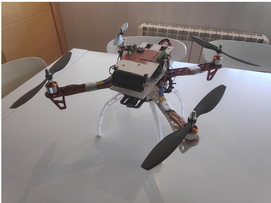
Figura 3.18. Dron del proyecto tras finalizar el montaje mecánico. (Fuente: Propia)
