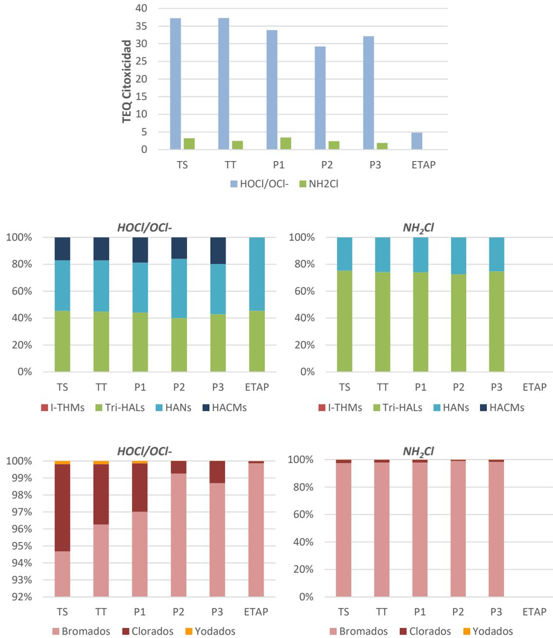
Figura 17. Potencia citotóxica de las matrices de agua expresada en concentración de equivalentes tóxicos (TEQ) y la contribución relativa (%) de las clases de DBPs y la presencia de yodo, bromo o cloro en dicha toxicidad, en función del proceso de desinfección.
