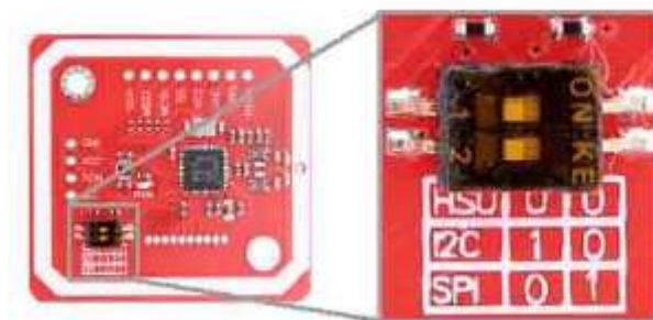
Ilustración 21: Jumper para la configuración del protocolo de comunicación del PN532. Fuente: (Laaroussi, 2019)
