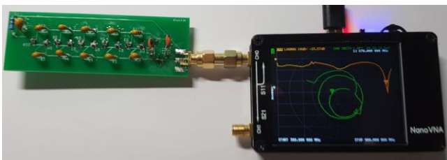
Fig. 11. PCB con los valores empíricos del acoplamiento \pi conectada al analizador vectorial.
