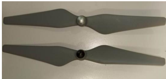
Fig. B.2 Hélices de sentido horario y antihorario
