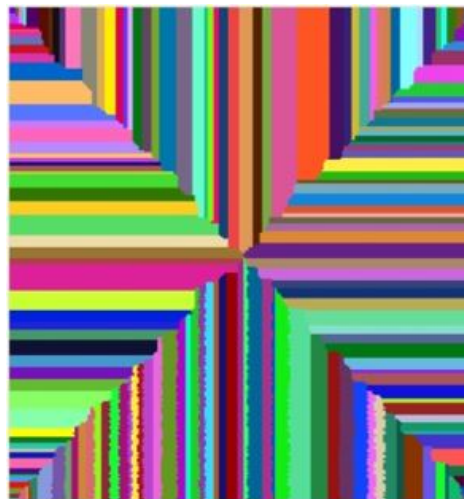
Fig 4.6. Estructura con granos de tipo columnar [12]
