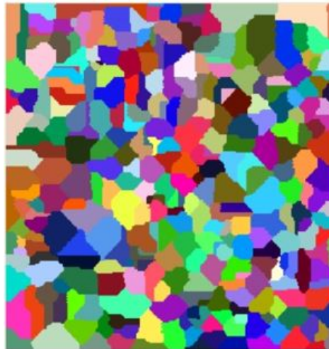
Fig 4.4. Simulación de la transformación líquido-sólido. Situación final [12]
