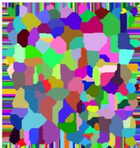
Fig 4.7. Estructura con granos de tipo columnar (bordes) y equiaxial (centro) [12]
