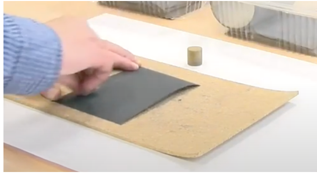
Fig 4.22. Representación gráfica del desbastado con papel de esmeril de 320 [13]
