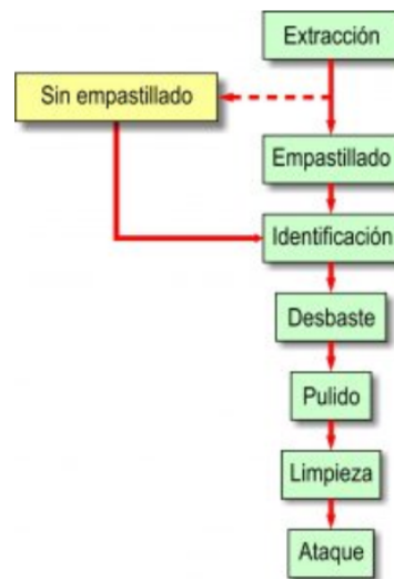
Fig 4.15. Secuencia de pasos para realizar una sesión de metalografía [12]
