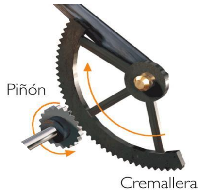
Ilustración 38. Sistema de transmisión piñón-cremallera curva xliv
