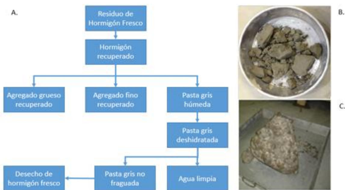
Figura 6.2 Proceso de generación de desechos de hormigón fresco (A), pasta gris deshidratada (B), desecho de hormigón fresco (C). Fuente: [21].
