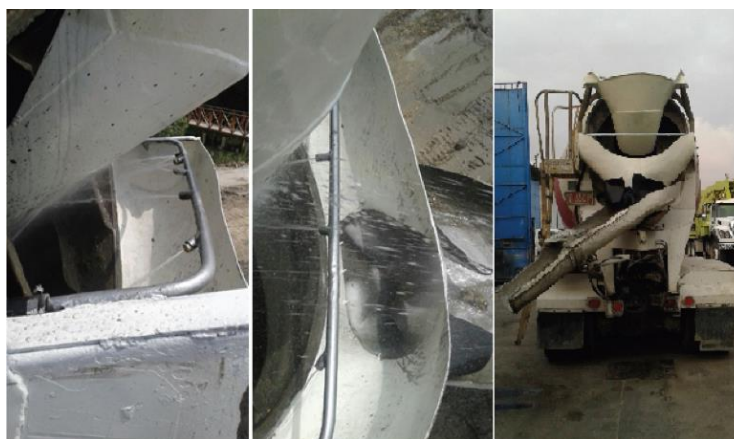
Figura 5.9 Sistema de lavado integrado. Fuente: [14, p. 13].
