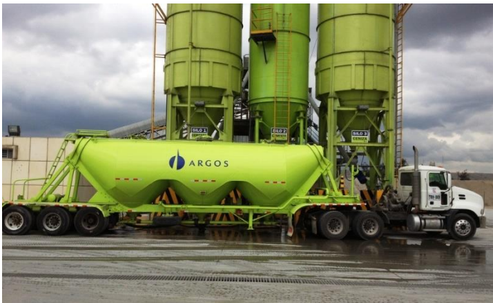
Figura 5.3 Camión Silo, realizando una entrega de cemento. Fuente: [11].
