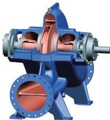
Figura 36: Modelo de una bomba centrifuga con doble aspiración y doble voluta. Fuente [7].
