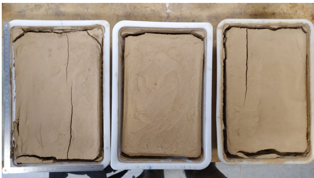
Figura 5.27. Aspecto final tras desecación de la Bandeja 1 (centro), 2 (derecha) y 3 (izquierda).
