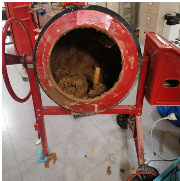
Figura 5.17. Mezcladora en funcionamiento durante la preparación del suelo.
