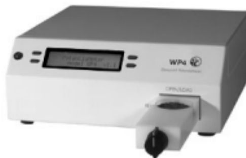
Figura 5.12. Higrómetro tipo WP4-T© utilizado para mediciones de succión (Decagon Devices Inc., 2007).
