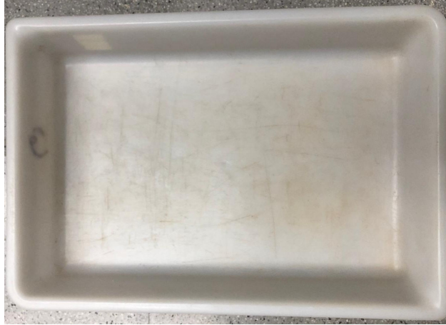
Figura 5.2. Bandeja rectangular tipo utilizada en el ensayo de desecación a pequeña escala.
