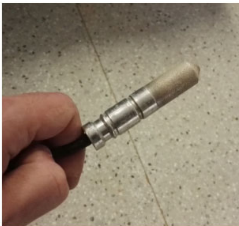
Figura 5.6. Sensor Vaisala HMP-230 que se coloca en los orificios laterales de la bandeja circular.
