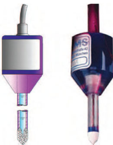
Figura 5.5. Tensiómetros tipo UMS-T5© (Meter Group, 2018).
