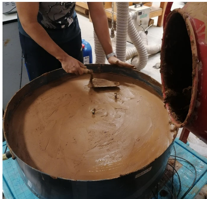
Figura 5.20. Proceso de aplanamiento de la superficie durante el vertido de la mezcla en la bandeja.
