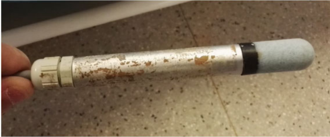
Figura 5.7. Sensor Vaisala HMD/W70 que se coloca en la cámara para tomar datos ambientales.
