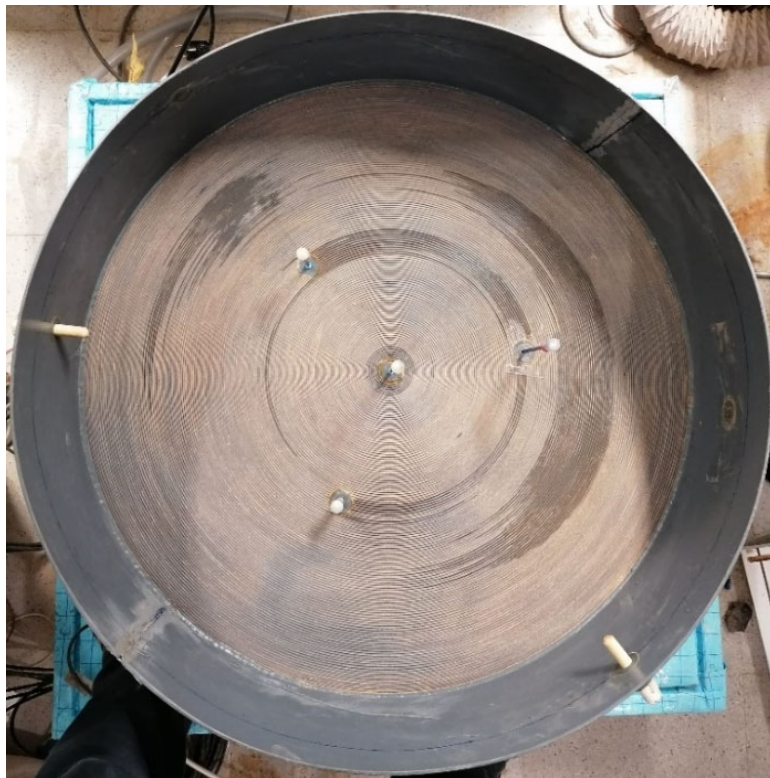
Figura 5.3. Bandeja circular utilizada en el ensayo de desecación a media escala.
