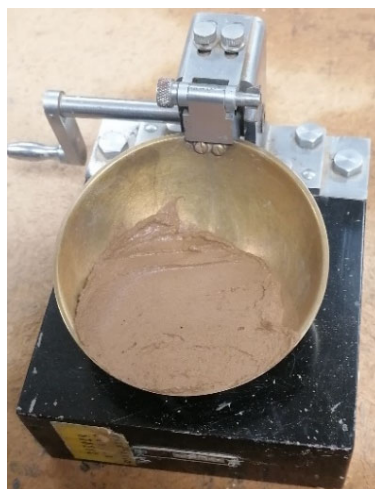
Figura 5.18. Ensayo de cuchara de Casagrande para el control del límite líquido durante la preparación.
