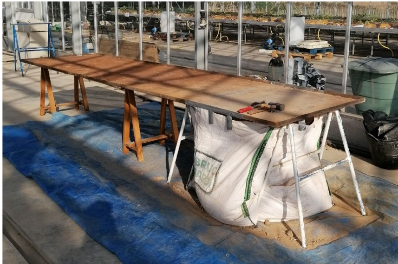
Figura 5.13. Estructura para el tamizado del suelo investigado.
