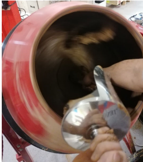
Figura 5.16. Procedimiento de preparación de una de las tandas de la mezcla de suelo.
