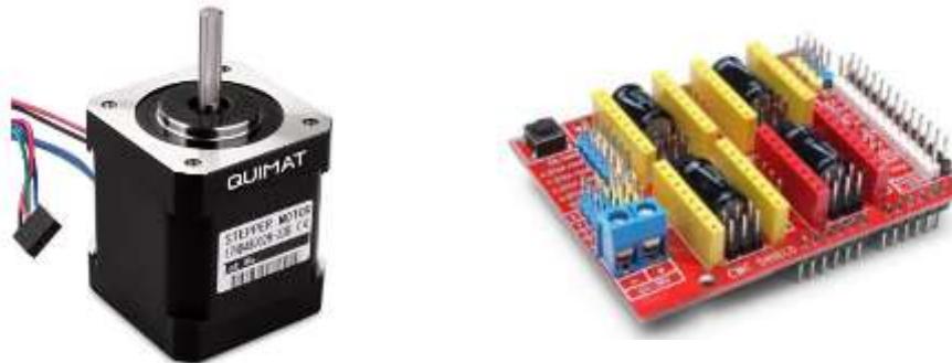
Figura 3: Motor NEMA 17 y CNC Shield V3
