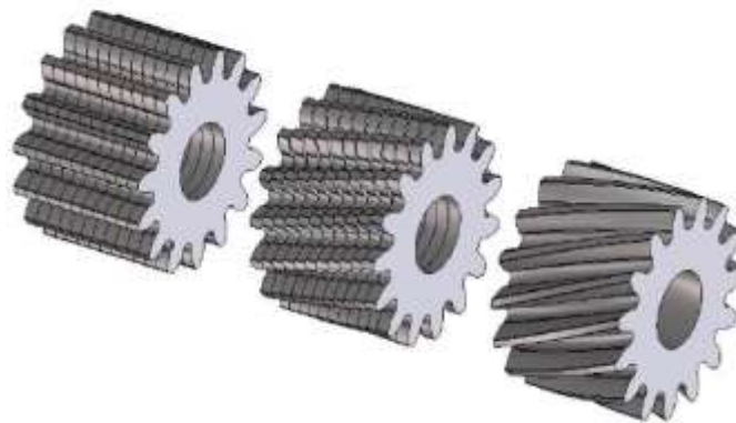
Figura 19: Generación del perfil helicoidal
