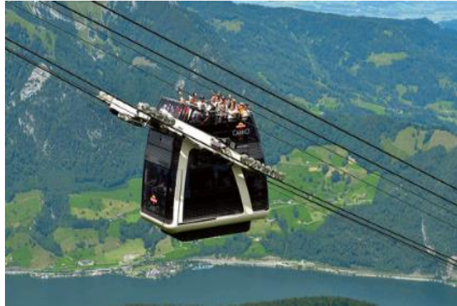
Figura 27: "Funifor" amb cabina de dos pisos. La superior no està coberta. (Stans, Suïza) [7]
