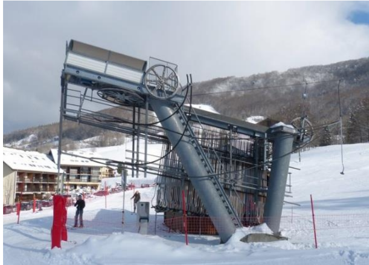
Figura 44: Estació motriu Genius de Pomagalski.
