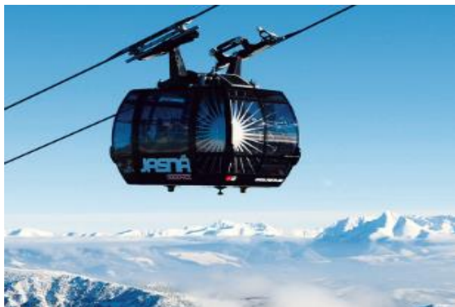
Figura 30: Cabina d'un "Funitel".
