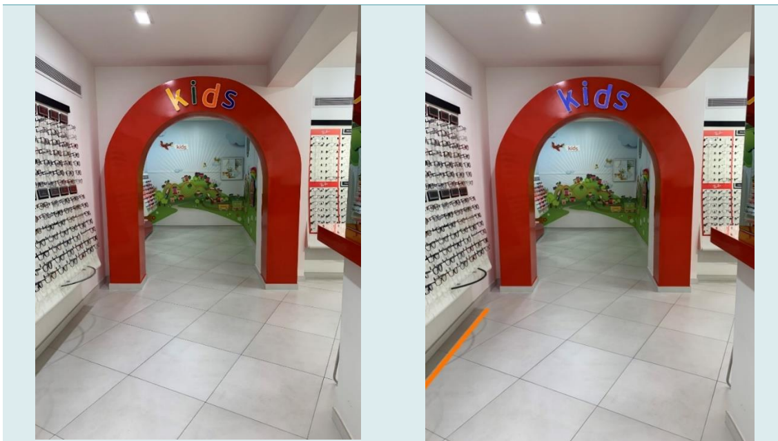
7. Lletres de colors no visibles per persones amb disfunció del color. Els mobles volants no poden senyalització al terra per als bastons
