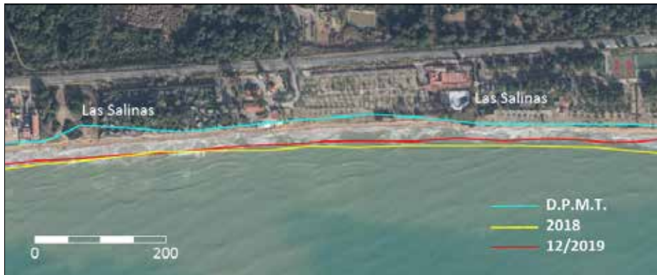
FIGURA 9. Configuració de la part central de la platja Llargueta de Tarragona després de l'impacte del Gloria . La fotografia és del vol efectuat per l'Institut Cartogràfic i Geològic de Catalunya (ICGC) els dies 24 a 27 de gener de 2020. Les línies de colors mostren la línia de riba a les dates que s'indiquen i han estat digitalitzades a partir de les imatges obtingudes en els vols realitzats per l'ICGC. S'assenyala la localització dels càmpings Las Palmeras i Las Salinas , que van ser afectats per l'impacte del temporal. Escala gràfica en metres. D.P.M.T.: línia de partió del Domini Públic Marítim-terrestre.
