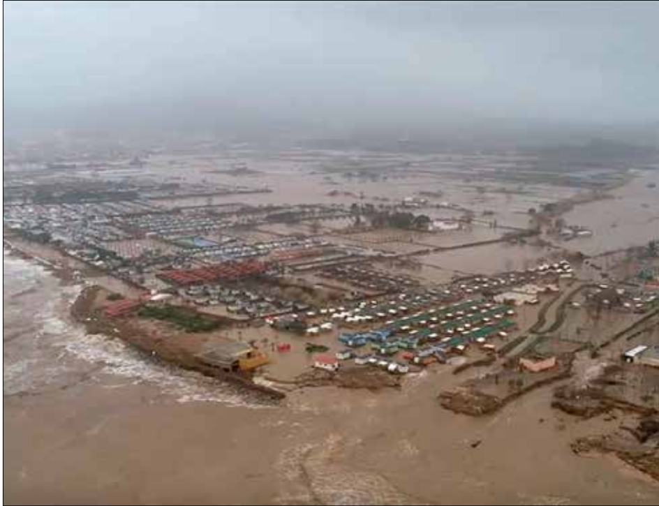
FIGURA 13. Inundació costanera a la riba dreta del delta de la Tordera a causa de l'acció combinada del riu i la mar. La inundació provocada pel mar es concentrà a la zona més propera a la platja, on aquesta fou ultrapassada per les onades. La major part de la gran inundació que s'observa, però, es deguda principalment al sobreiximent del riu (del Cos d'Agents Rurals).
