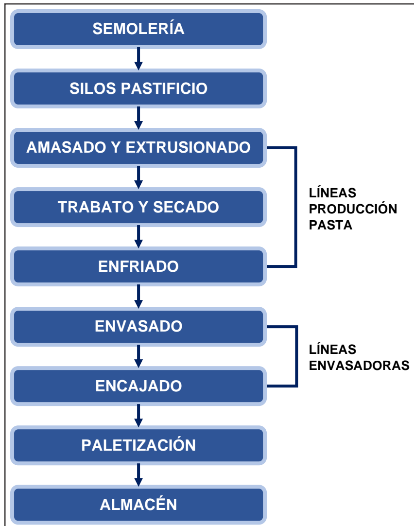
Figura 22: Esquema productivo de pastificio en PAG.
