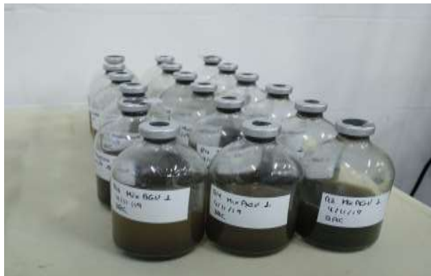
Figura 4: Sistema del ensayo de actividad metanogénica. Autor: Beatriz Ruiz Conde.
