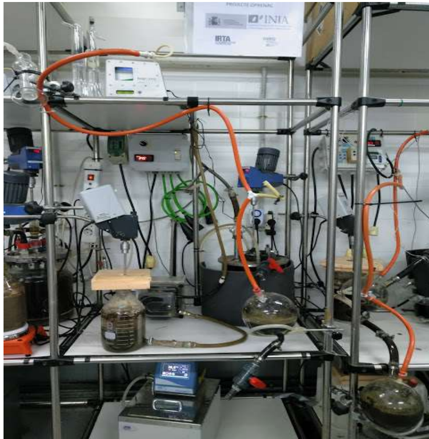
Figura 2: Imagen del montaje de laboratorio del reactor de digestión anaerobia. Autor: Beatriz Ruiz Conde
