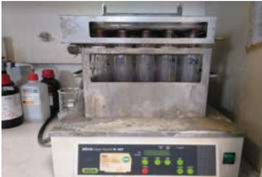
Figura 6: Digestor para la determinación del N. Kjeldhal. Autor: Beatriz Ruiz Conde.
