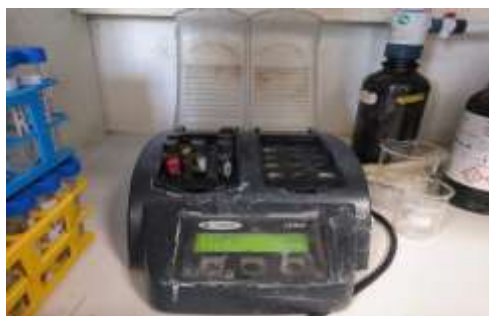
Figura 5: Digestor térmico para el análisis de la DQO. Autor: Beatriz Ruiz Conde.
