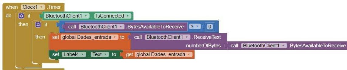
Figura 4.46: Blocs per rebre i visualitzar les dades del sensor.
