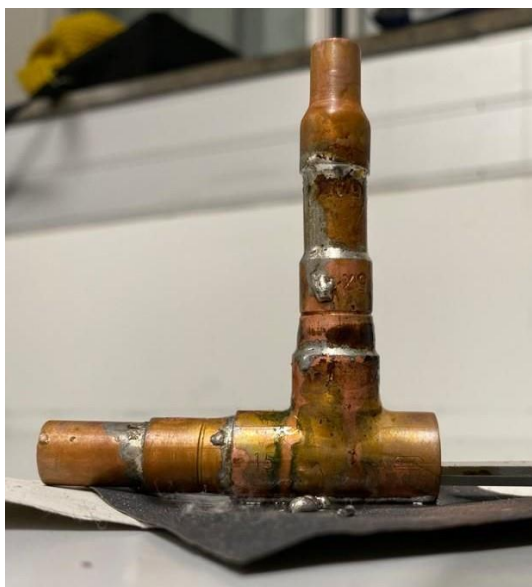
Figura 5.1: Peça tubular en forma de T un cop soldada.
