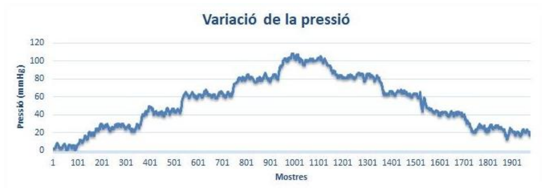
Figura 6.40: Variació de la pressió al sensor en una presa de mostres constant.
