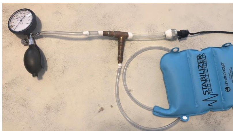
Figura 5.2: Muntatge físic acabat. Al centre hi ha la peça tubular, a l'esquerra el manòmetre analògic, a la dreta el sensor i a baix el coixí. També s'aprecia en blanc les juntes cobertes de tefló.
