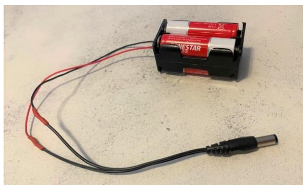
Figura 5.3: Porta-piles amb quatre piles connectat a un Jack per fer de font d'alimentació de l'Arduino i no haver de dependre de l'ordinador.
