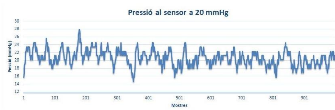
Figura 6.32: Variació de la pressió fixa de 20 mmHg de les mostres obtingudes amb filtre.
