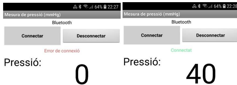
Figura 6.43: A la pantalla de l'esquerra mostra el missatge que surt quan no s'ha pogut connectar el Bluetooth. La de la dreta mostra el Bluetooth connectat i rebent una pressió de 40 mmHg.
