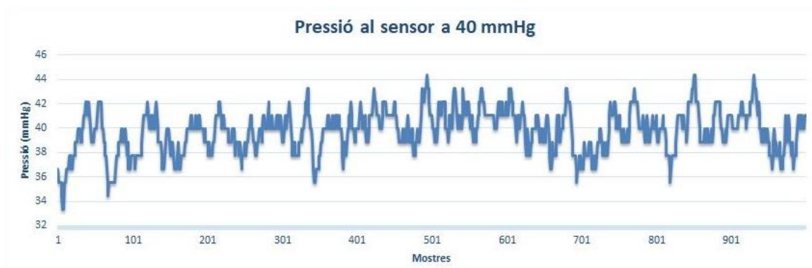
Figura 6.33: Variació de la pressió fixa de 40 mmHg de les mostres obtingudes amb filtre.
