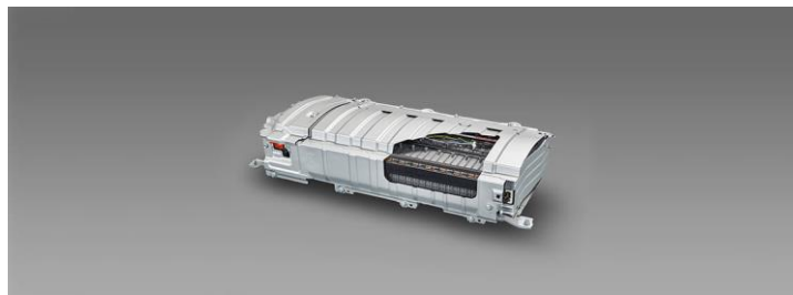
Figura 2.8: Bateria de Ni-MH del Toyota Prius. Font: [10]
