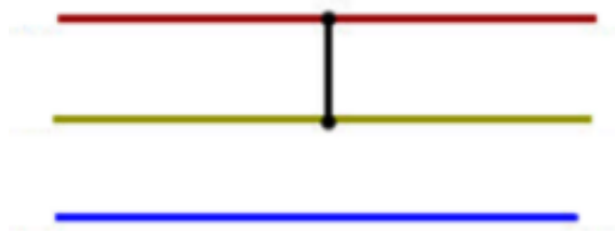
Figura 10: Contacto fase - fase. Fuente bibliográfica [11]
